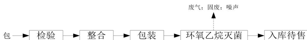
图 2-9 现有项目急救用品包生产工艺流程示意图
